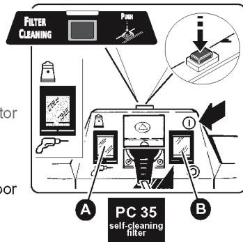
**ES** Limpie el filtro con frecuencia utilizando un pincel con cerdas suaves / Para limpiar a fondo el filtro dirija un chorro de agua desde el interior hacia el exterior / Antes de volver a montar el filtro, compruebe que se haya secado del todo / Sustituya el filtro **únicamente** si está desgastado.
