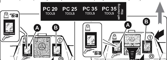
ES Con el interruptor ("B") en posición **I**, cuando se pulsa el desviador ("A") en posición "AUTOMÁTICO" (), se activa la función de limpieza del cartucho del filtro (Self Cleaning Filter).
